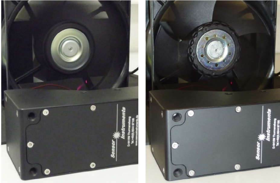
Detektieren und Zählen der Rotorblätter mit dem Laser-Reflexlicht-Kantendetektor RED-50-L
